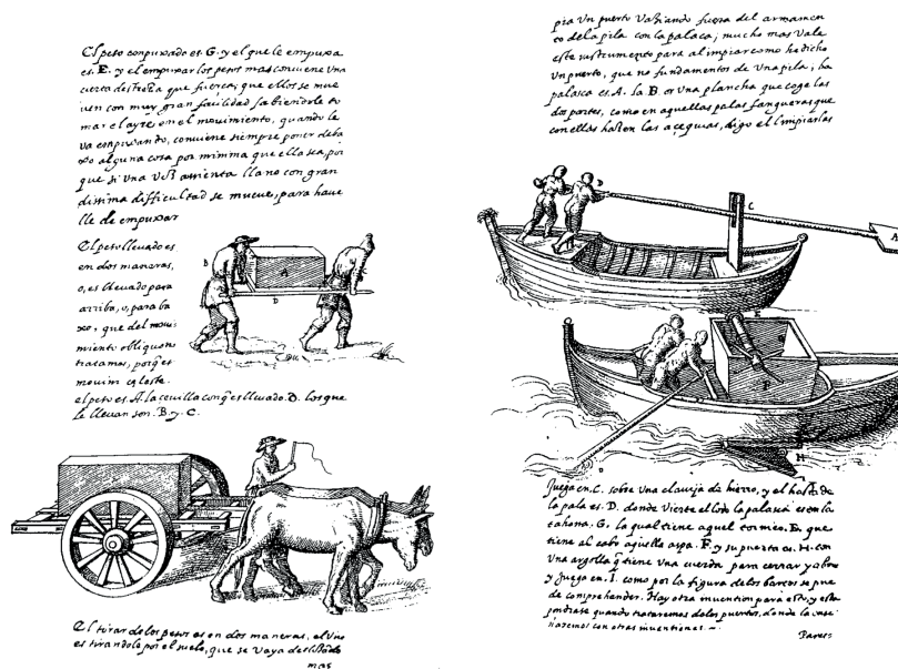
Fig. 4. Trasporto di conci di grosse dimensioni a braccia o con carri ed esempi di imbarcazioni impiegate per costruzioni idrauliche; P. J. de Lastanosa, Los veintiún libros cit. , cc. 386v, 382v (montaggio dell'autore).
